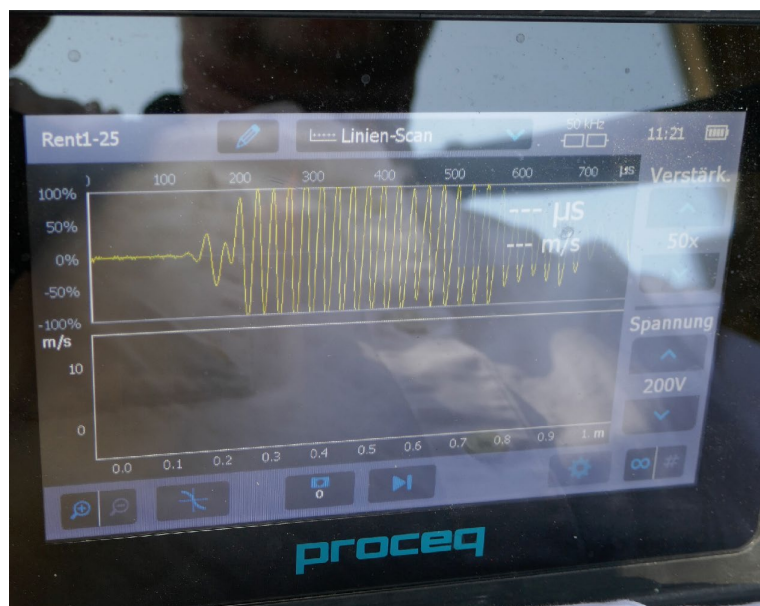
Abb. 6 Erfassung der Laufzeit des Kompressions- wellenimpulses
