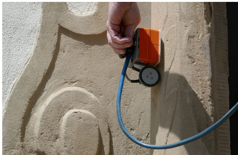
Abb. 7 Durchstrahlung der Säulenschäfte mit einem 2-GHz-Radarsensor
