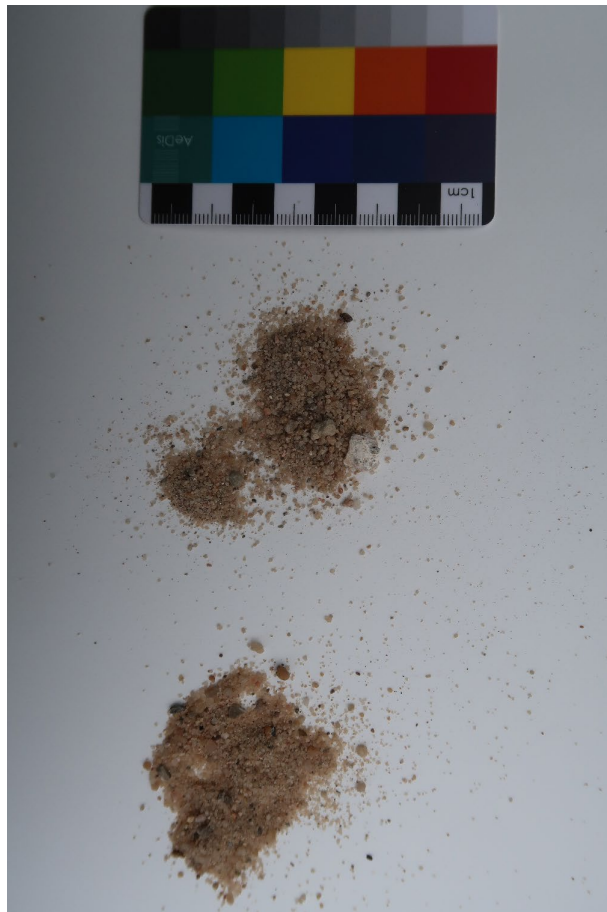
Abb. 4 Zuschlag des Bestandputzes nach Auflösung des Kalkbindemittels (oben) und Sandmuster für Neuputz (unten) – Schwäbisch Hall, OT Steinbach, St. Johannes Baptist, 2023 (AeDis AG)
