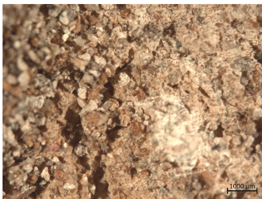
Abb. 4 Mikroskopische Ansicht des Mauer- und Fugenmörtels im Gewölbe, datiert auf die erste Hälfte des 16. Jahrhunderts
