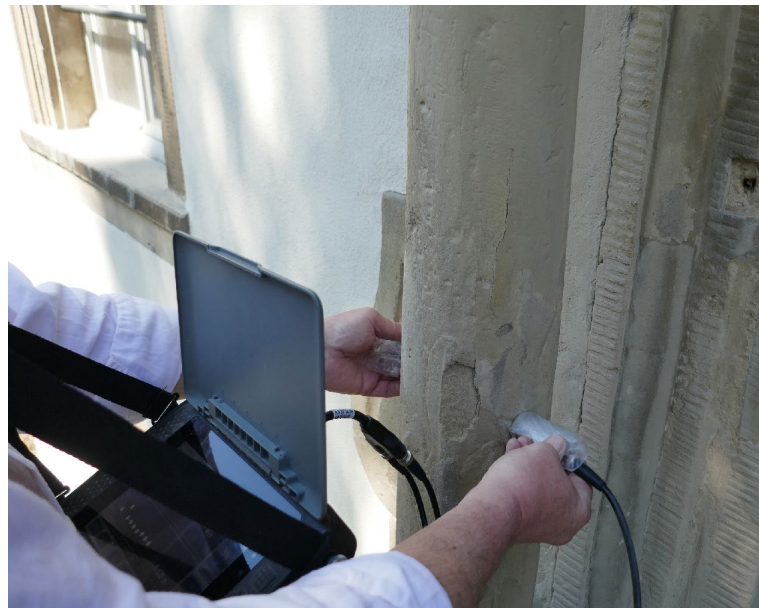
Abb. 5 Durchschallung der Säulenschäfte
